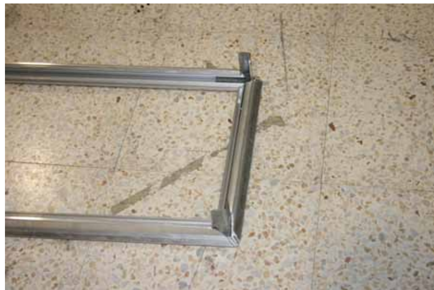
SE AJUSTAN LAS ESQUINAS
