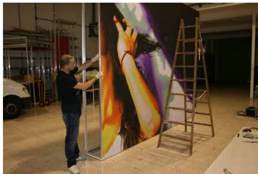
SEGUIMOS METIENDO LA SILICONA POR LOS LATERALES
