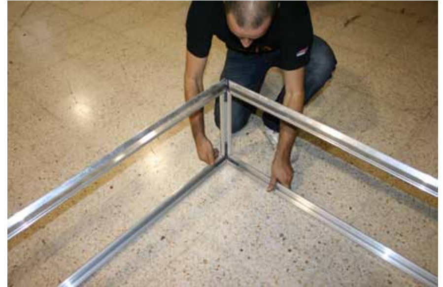
SE AJUSTA Y DESPUES SE APRETAN TODOS LOS TORNILLOS
